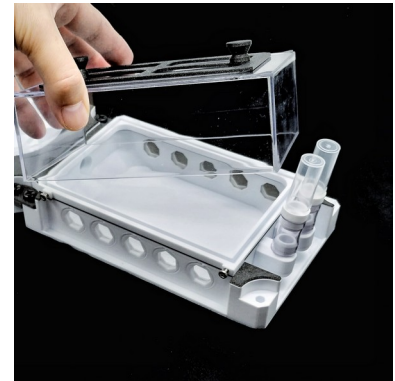
写真 15 クリアカバーの取り外し
